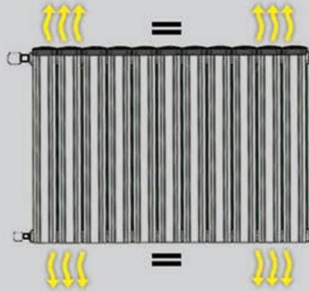
وجود تفاوت دما در رادیاتورها به خصوص در زمان کاهش فشار، همیشه مشکل ساز بوده و لوله کشی غیر استاندارد، پمپ ضعیف پکیج، عدم استفاده از سیستم تقسیم مناسب آب، طولانی بودن مسیر آب و موارد مشابه این مشکل را دوچندان می کنند. آنیت، برای اولین بار توانسته با طراحی و توسعه تکنولوژی های نوین، مشکل وجود تفاوت دما در ابتدا و انتهای رادیاتور را حل نماید و محصولات خود را به نحوی تولید نماید که در دبی های پایین نیز بهترین عملکرد را داشته و به صورت یکنواخت گرم شوند.
